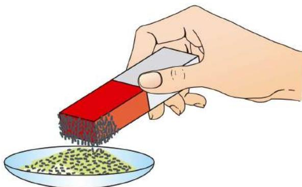
*Imagen 1: Separación de una mezcla de azufre y limaduras de hierro.*
