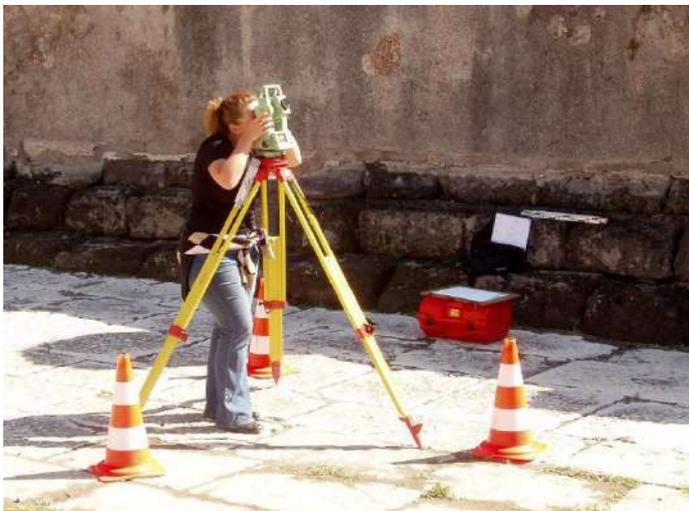
Con un teodolito, se pueden medir ángulos, tanto en el plano vertical como en el horizontal, que nos permiten, aplicando las razones trigonométricas, hallar distancias o calcular alturas de puntos inaccesibles.
