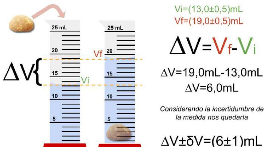
Imagen 7: Método para determinar el volumen de un sólido irregular.
